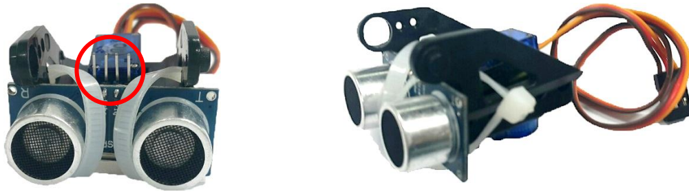
<그림 1-4-7> 초음파센서, 서보모터 홀더와 결합한 모습
