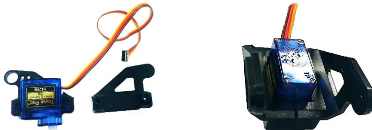
<그림 1-4-6> 서보모터, 서보모터홀더와 결합한 모습
