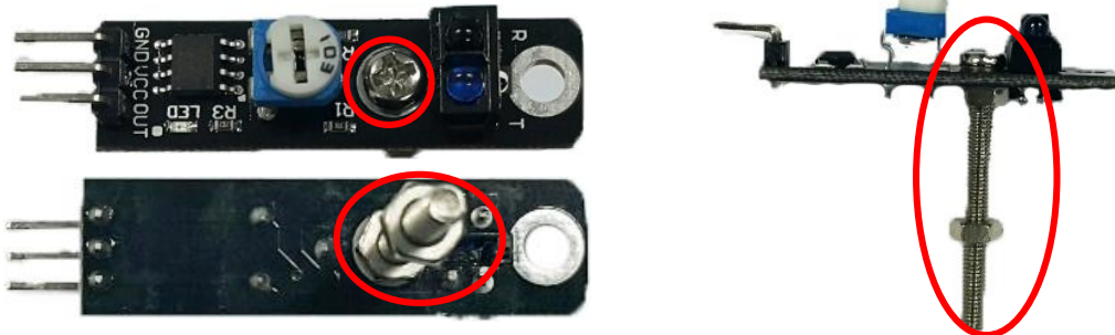
<그림 1-4-2> TCRT5000 적외선 라인 트래킹(추적)모듈 결속 모습
