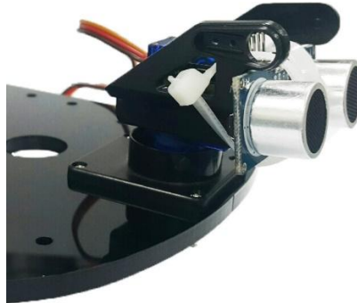
<그림 1-4-9> 초음파센서와 서보모터, 서보모터 홀더가 차대와 연결된 모습
