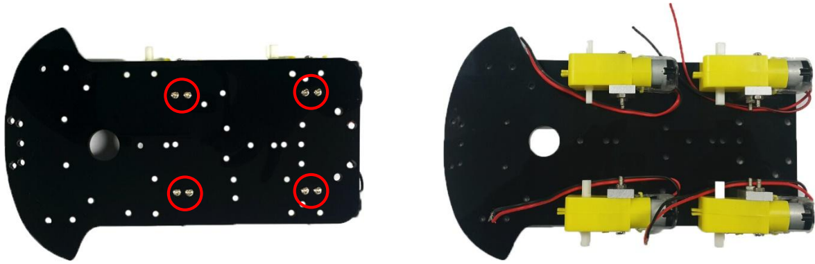
<그림 1-3-4> 차대와 DC 모터가 연결된 사진(위/아래)
