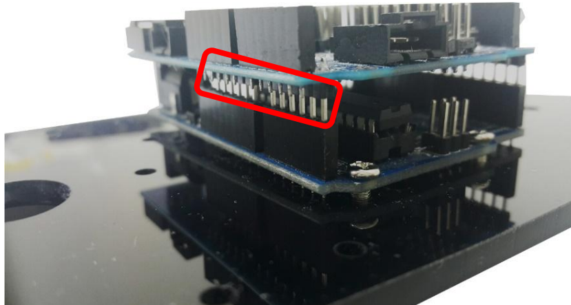
<그림 1-2-5> 아두이노 우노 보드에 센서확장실드 장착
