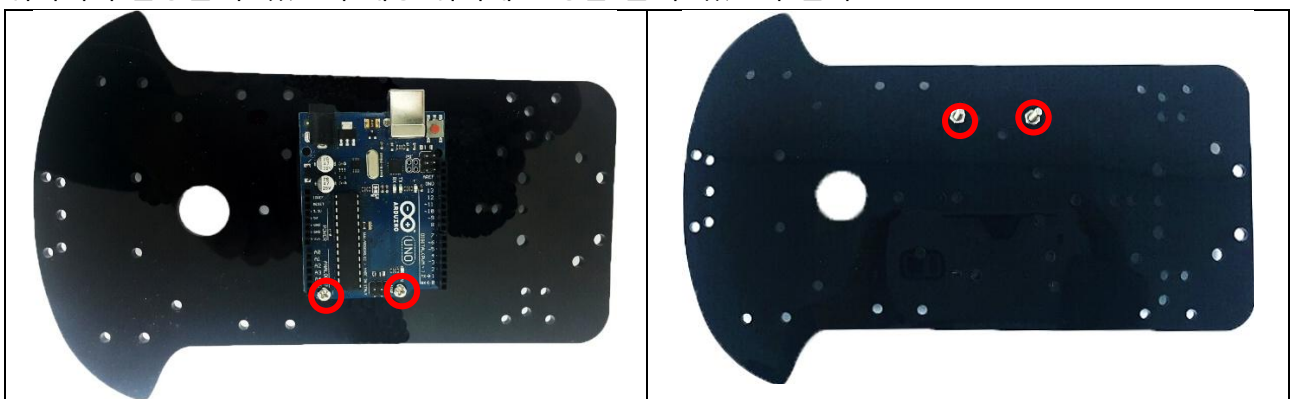
<그림 1-2-3> 차대와 아두이노 우노 보드를 결합한 모습(위 / 아래)
