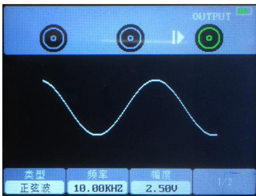
7. 用示波器观察到的 Gen Out 端子输出波形如下图：
