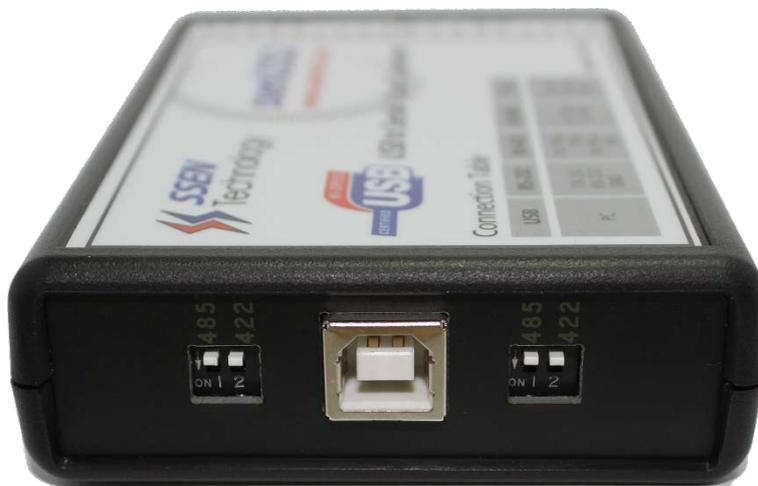
제품 좌측면 중앙에 위치한 USB 커넥터에 함께 제공된 USB 케이블을 연결합니다. 커넥터 좌, 우측에 있는 2개의 스위치는 시리얼 포트 A와 B의 종단 저항을 설정하는 스위치입니다. 종단 저항은 RS-485와 RS-422로 구분되어 있으며 사용하시는 시리얼 인터페이스에 따라 선택하여 사용할 수 있습니다. 종단 저항을 삽입하고자 할 경우 스위치를 아래쪽 (ON) 방향으로 내리면 종단 저항이 삽입 됩니다. Differential Signal 을 사용하여 통신하는 경우 종단 저항이 사용되는데, 일반적으로 라인 양쪽 끝에 위치한 디바이스에서 종단 저항을 삽입합니다. 따라서, 종단 저항이 설치되어 있는 시리얼 네트워크에서는 종단 저항을 사용 할 필요가 없습니다. 노이즈가 극심한 환경에서는 종단 저항을 추가로 사용하면 통신 에러가 개선되는 효과를 기대할 수 있습니다.
