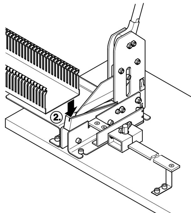
3. Verdrahtungskanal gegen den Längenschieber schieben.
