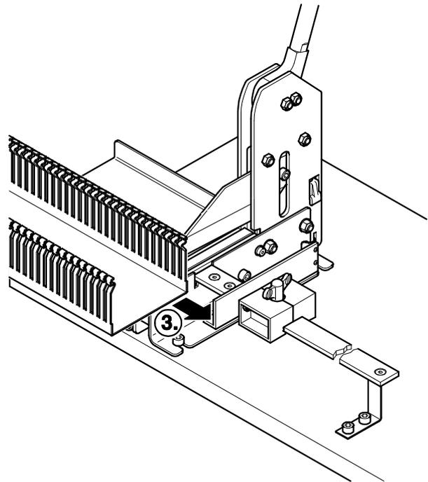
4. Verdrahtungskanal an die Gestellplatten schieben. Befindet sich im Schneidbereich kein Schlitz, Verdrahtungskanal bis zum nächsten Schlitz zurückschieben oder die im Schneidbereich liegenden Stege ausbrechen.
