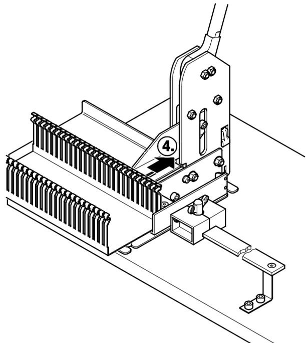
5. Hebel nach unten ziehen. Der Hebel muss mit einer Hand bedienbar sein. Ansonsten ist das Messer stumpf oder der Gegenhalter abgenutzt.
